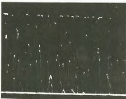
Figura 3. Sempre all'oscilloscopio, ma all'uscita dello stadio di amplificazione, la differenza delle tensioni alterate supera i 6 volt dell'alimentazione: si verifica un livellamento dei picchi inferiori e superiori.
