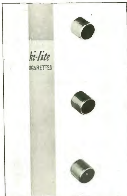
Figura 9. Oltre alle interessanti qualità elettriche, il microfono a condensatore offre il vantaggio di un ingombro notevolmente ridotto.
